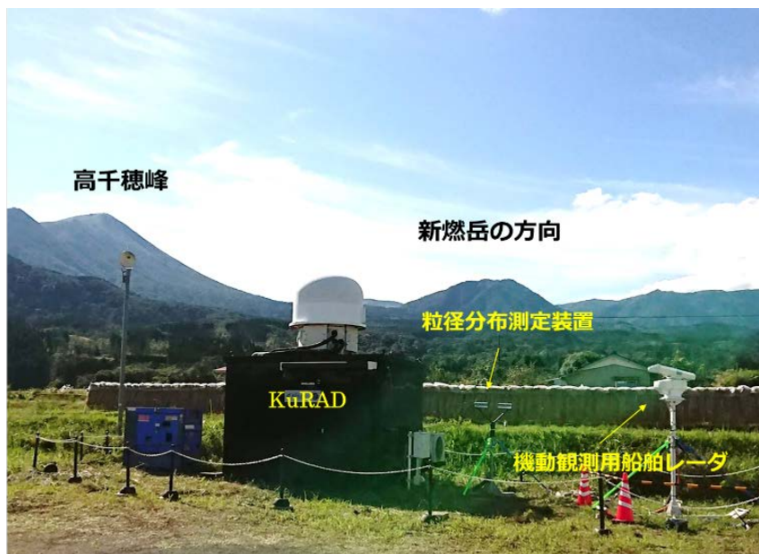
写真-5 新燃岳火山噴火の観測のために設置された鹿児島大学の火山観測用レーダ（KuRAD）、降灰粒子測定装置、機動観測用船舶レーダ（宮崎県高原町南狭野活性化センター敷地内）
