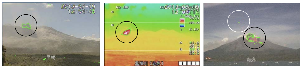
図2 画像による検知事例(左:可視画像、中央:赤外画像、右:噴石検知事例) (緑線は噴火として判断された画像の輪郭を示している)
