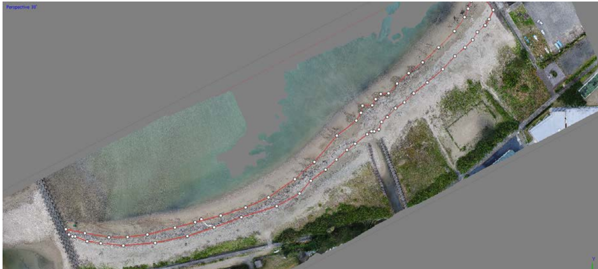
写真-A 奄美大島のC海岸での油類漂着状況のオルソ画像（赤線で囲む領域が油類の主な漂着領域である）
