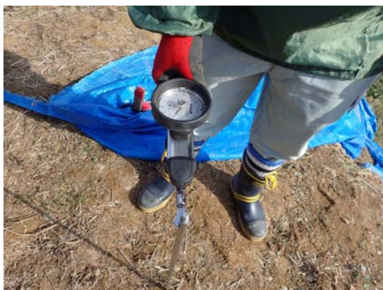
写真-4 ペーンコーン貫入試験
