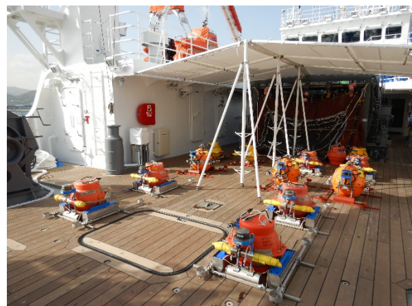
本航海で設置した各種海底地震計
