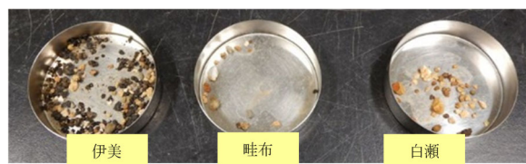
図 3 2mm ふるい水洗残留炉乾試料
