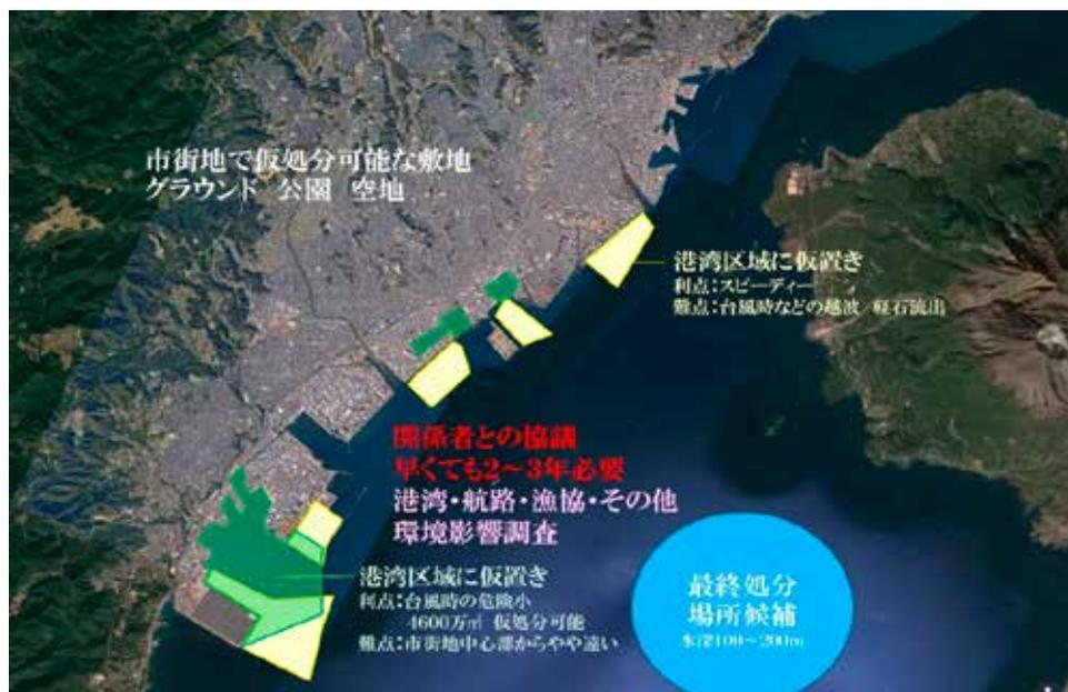
図-2 軽石搬出基地及び最終処分場所候補地案（平成 30 年レポート）
