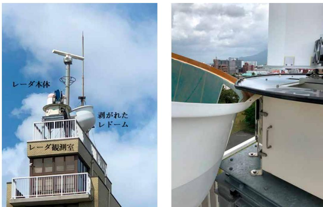
図 3.2.1 左：レーダ本体と剥がれたレドーム，右：レーダドーム接続部。
