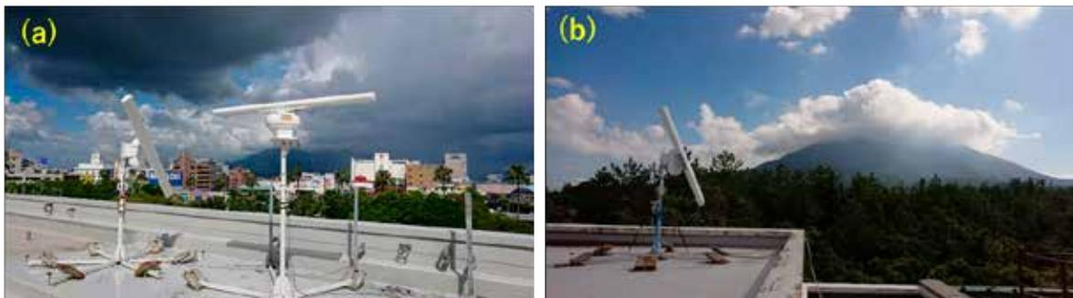
図 3.3.3 固体化素子タイプの X バンド船舶レーダの外観．(a) 鹿児島大学下荒田キャンパス水産学部 1 号館屋上での観測風景（2019 年 8 月 22 日撮影）．左は 400W レーダによる RHI 観測，右は 200W レーダによる PPI 観測．(b) 京都大学防災研 SVO の屋上へ移動しての RHI 観測（2021 年 10 月 8 日撮影）．固体化素子レーダは（株）光電製作所からの貸与による．
