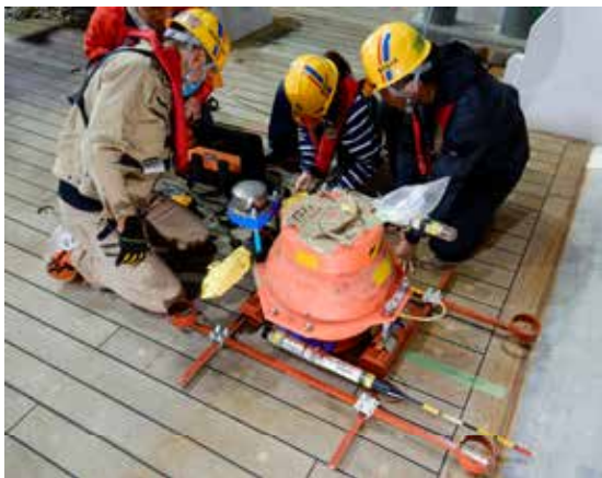
海底地震計の投入前作業(2021年4月)
