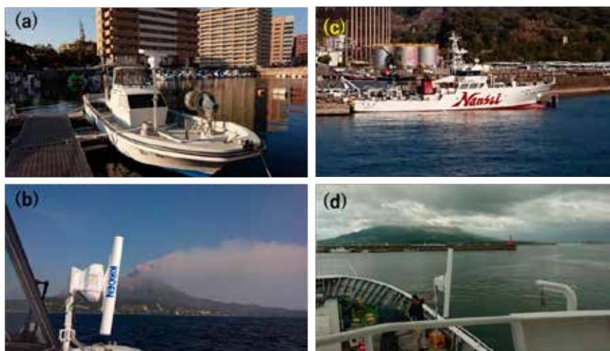
図 3.3.6 固体化素子船舶レーダによる海域での機動的降灰観測実験。(a) 鹿児島大学水産学部の小型ボートにセットされた固体化素子レーダ, (b)小型ボートによる桜島噴煙の観測風景。(c) 鹿児島大学水産学部の練習船「南星丸」。(d) 「南星丸」に設置された固体化素子レーダ。
