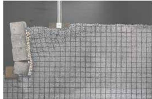
写真-8 ブロック擁壁の崩壊 (バルサ材)
