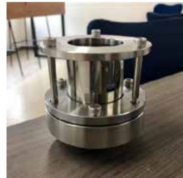
写真-3 改良ペDESTAL
