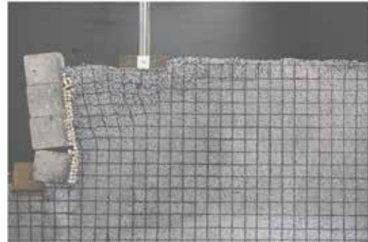
写真-8 ブロック擁壁の崩壊 (バルサ材)
