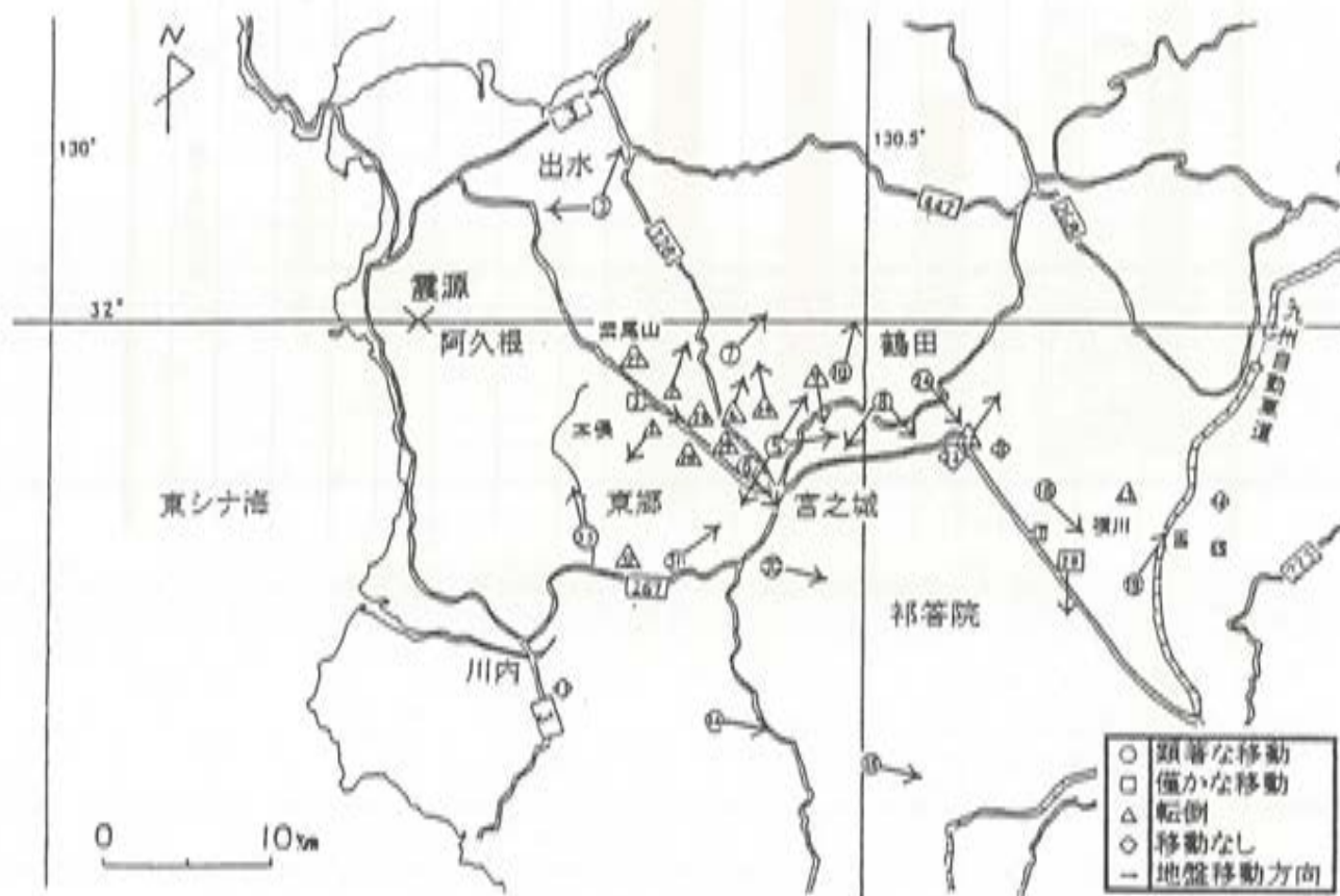
図-5.2 墓石の移動方向から推定した地震動の卓越した方向（第一本震）
