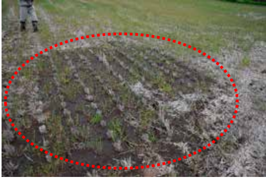
写真-4.1 液状化の痕跡 (南阿蘇村)
