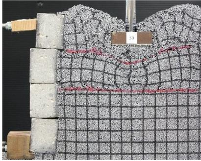
図-7 地盤の変形（紙2枚補強）
