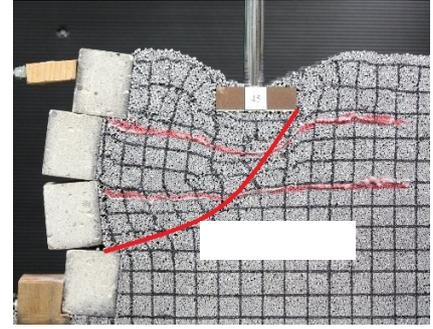
図-8 地盤の変形（ガーゼ2枚補強）
