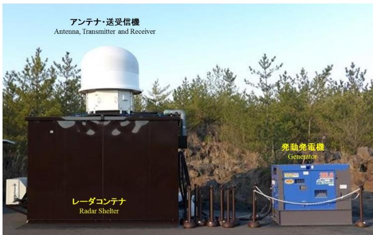
写真 1 火山観測用 Ku バンド高速スキャンレーダ (KuRAD) の概観
