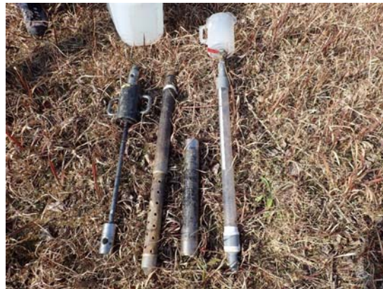
写真-5 原位置透水試験装置
