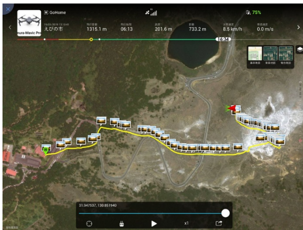
図 6 電波を失うまでのドローンの軌跡
