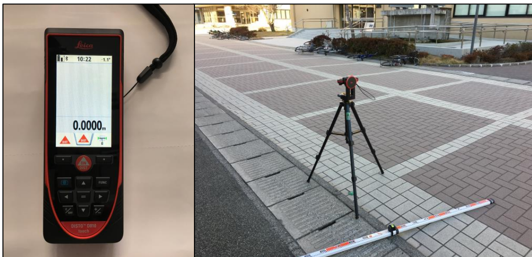
写真-2 使用機器と三脚への取付け状況
