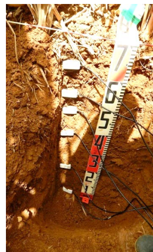
図12 土壌水分計の埋設状況
