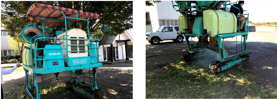
図-2 サイクロン式吸引洗浄装置
