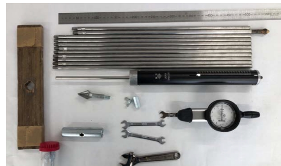
写真-5 土層強度検査棒一式
