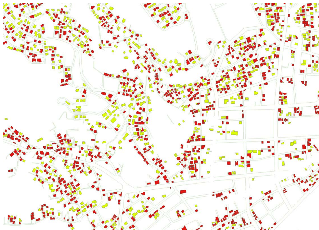
図7 一般道路から 2m 以内にある倒壊住宅は21,681棟（赤で示した住宅）
