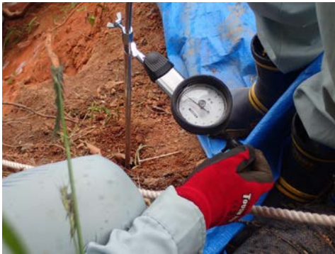
写真-6 ベーンコーン貫入試験
