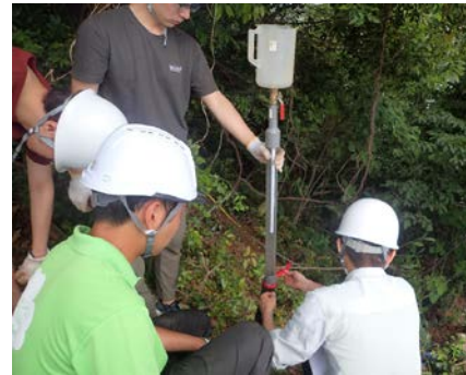
写真-7 原位置透水試験
