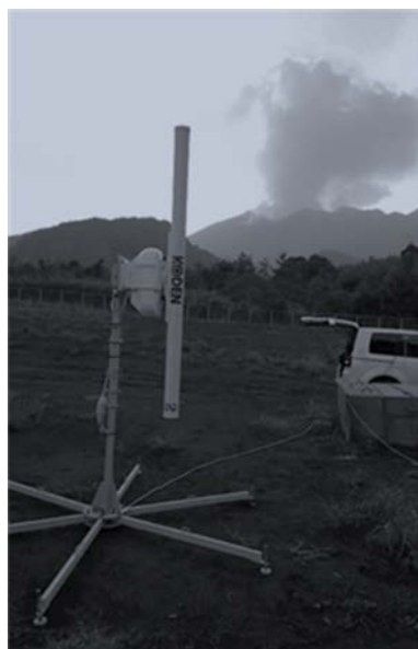
図 1 マグネトロン船舶レーダの外観（FRS コーポレーション所有。遠方に見えるのは桜島南岳と噴煙）
