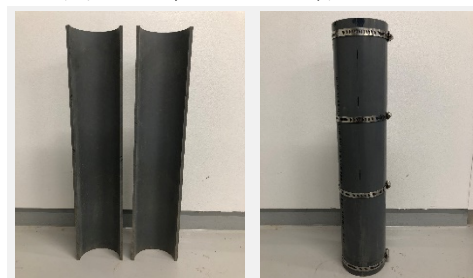
写真1 塩化ビニール管モールド
