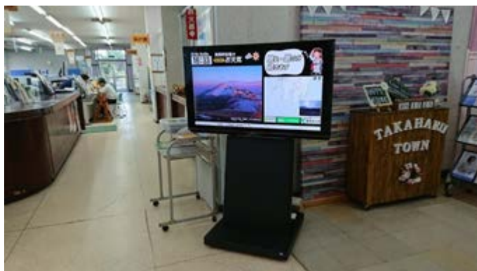
図3 宮崎県高原町役場の1階ロビーに設置された鹿児島大学のデジタルサイネージモニター。平時は15分先の雨の予報情報や地域の情報を配信する。台風接近時には台風経路予想図が、また、地震発生時には震度分布の情報が自動的に表示される。
