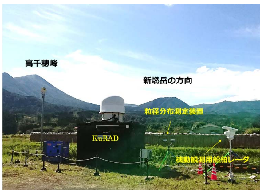
写真-5 新燃岳火山噴火の観測のために設置された鹿兒島大学の火山観測用レーダ（KuRAD）、降灰粒子測定装置、機動観測用船舶レーダ（宮崎県高原町南狭野活性化センター敷地内）
