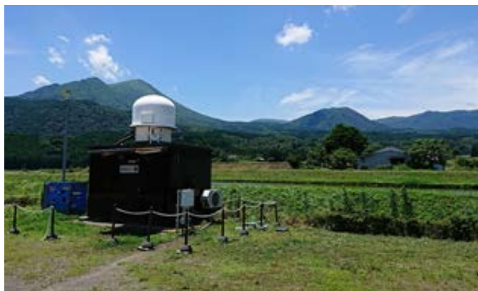
図2 新燃岳の降灰観測のために2018年に宮崎県高原町に設置された鹿児島大学Kuバンドドップラーレーダ。2019年度には桜島降灰観測のために鹿児島大学下荒田キャンパスに移設する予定。なお、新燃岳の噴火の恐れがある場合には、Xバンド船舶レーダによる機動的な観測により降灰情報の表示をおこなう。
