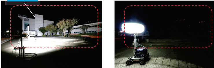
図 FGHP®ライトとバルーンライトとの比較 (同じ露光・シャッタースピード・ISO感度で撮影)
