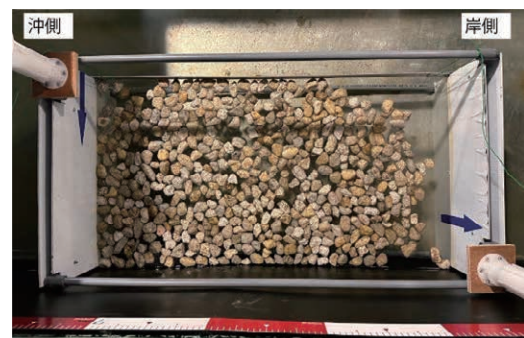
写真-2 模型内部の堆積軽石群
